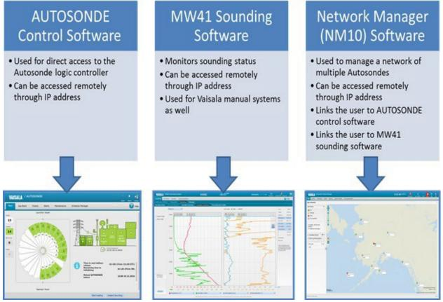
Figure B-8: Autosonde Software Interfaces
