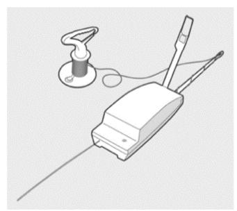
Figure C-17: Radiosonde RS41-SGP and Unwinder
